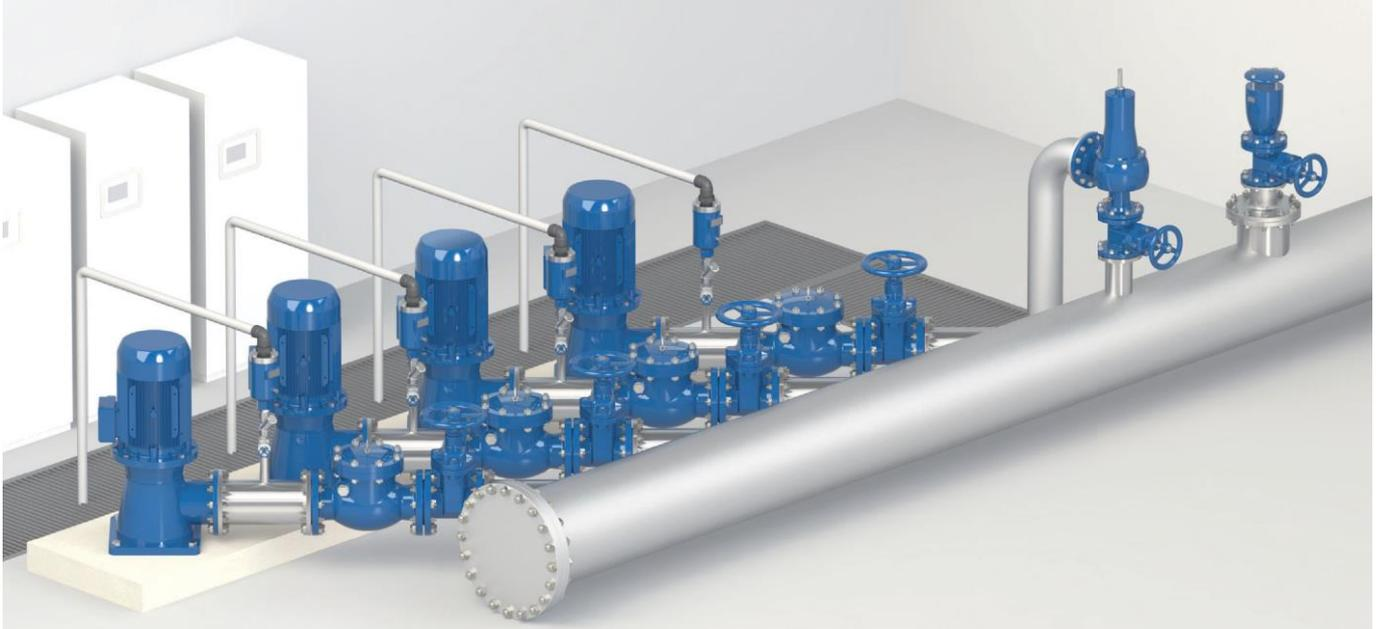
**Станція редукційного клапана.** У цьому другому прикладі Gemina встановлюється після станції редукційного клапана, щоб у будь-якому випадку запобігти підвищенню тиску в магістралі. Установка також включає редукційний клапан CSA XLC 310/410, байпас для технічного обслуговування та комбіновані повітряні клапани проти помпажу FOX або LYNX 3F AS вище та нижче за потоком.
